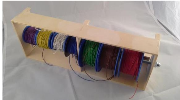
Für 3 grosse oder 4 kleine Spulen pro Seite. Je nach Durchmesser können die Spulen hinten herausstehen. Die Achse besteht aus einer Gewindestange M8.
